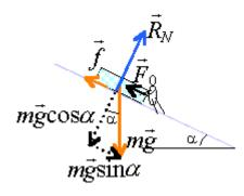
Projetons ces forces sur un axe perpendiculaire à la pente
