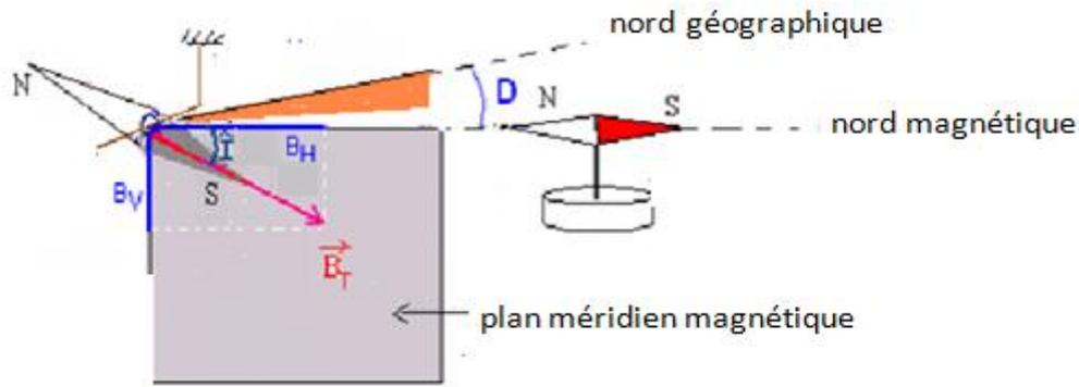
L'aiguille aimantée placée sur un axe verticale prend toujours la direction de la composante horizontale du champ magnétique terrestre  $\vec{B}_H$ .
