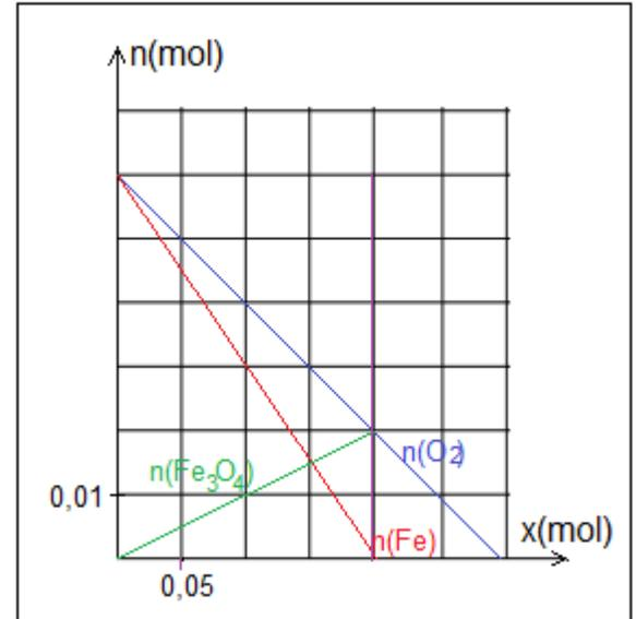
$$\Rightarrow \begin{cases} n_0(Fe) = 3x_{max} = 0,015 \text{ mol} \\ n_0(O_2) = 2x_{max} = 0,010 \text{ mol} \end{cases} \Rightarrow \begin{cases} m_0(Fe) = n_0(Fe) \cdot M(Fe) = 0,015 \times 56 = 0,84 \text{ g} \\ V(O_2) = n_0(O_2) \cdot V_m = 0,010 \times 24 = 0,24 \text{ L} \end{cases}$$
