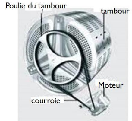
1. Calculer la fréquence de rotation du moteur en tours par seconde. **0.5pt**
